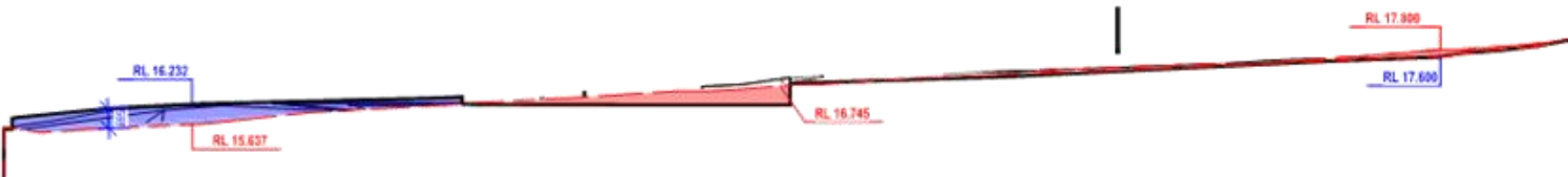
4 Cut & Fill Section 3 1 : 200
